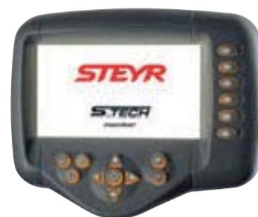
**Der S-TECH-Monitor von STEYR.** Über diesen Bildschirm kontrollieren Sie jedes ISO 11783-kompatible Anbaugerät und erhalten entsprechende Anzeigen.
