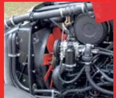
**ECO-Lüfter\*.** In Abhängigkeit von der Betriebstemperatur wird der Winkel der Lüfterflügel verändert, wodurch Kraftstoff gespart wird. Durch eine Richtungsumkehr des Luftstroms wird der Lüfter automatisch gereinigt. Diese Funktion kann auch über das Easy Tronic Vorgewende-Management gesteuert werden.
